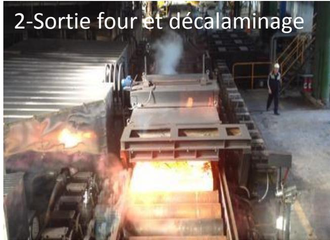
3 Sortie four et décalaminage
