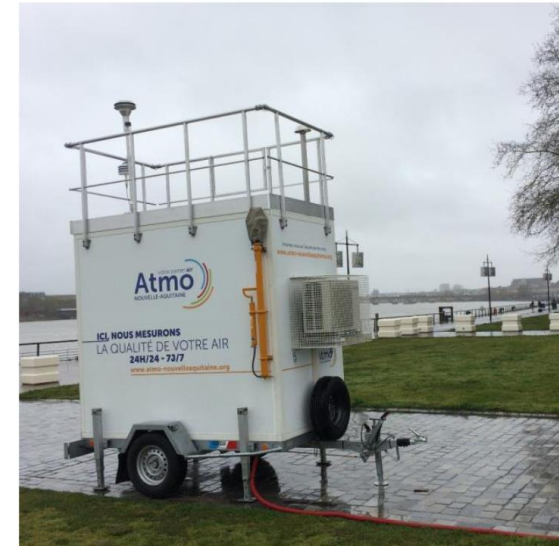
Figure 3 : laboratoire mobile pour la mesure des particules en continu
