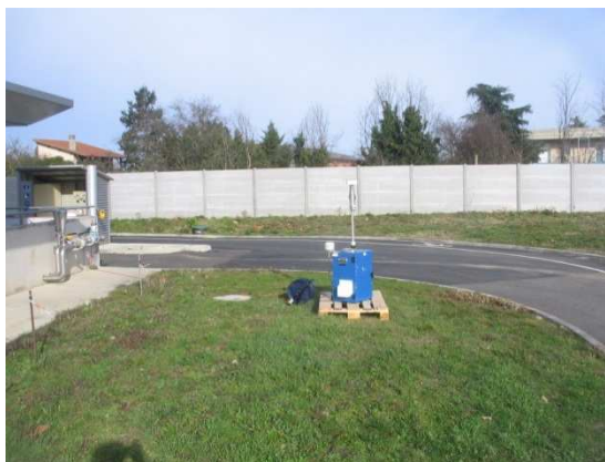
Exemple de préleveur automatique Partisol
