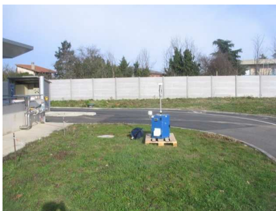
Exemple de préleveur automatique Partisol
